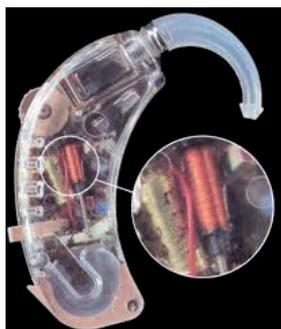
*Der Name T-Spule rührt daher, dass dieser Bausatz im Hörgerät ursprünglich dazu diente, das Telefon nutzen zu können. Tatsächlich bauten die alten Festtelefone ein Magnetfeld auf, das dann mittels „T-Spule“ genutzt werden konnte. Dies ist heutzutage nicht mehr der Fall, auch nicht bei den neueren Festnetztelefonen.*
