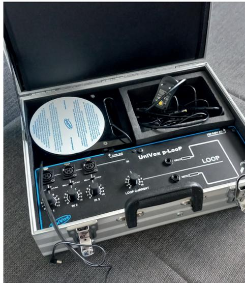
*Koffer mit integriertem Stromverstärker und beiliegender handlicher Kabelrolle mit Verlegedraht, sowie Netzteil zur Stromversorgung*
