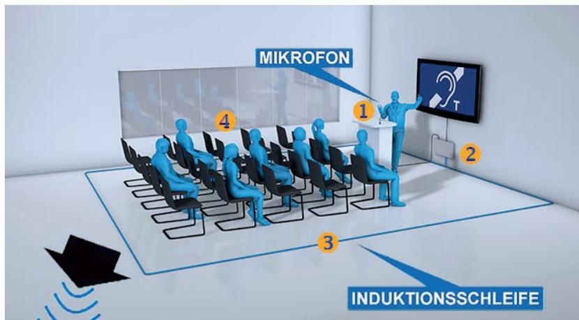
Der Vortragende spricht ins Mikrofon (1), das an einen speziellen Verstärker angeschlossen ist (2). Eine Metallschleife wird mit beiden Enden an diesen Verstärker angeschlossen, nachdem sie rundherum im Vortragsraum verlegt wurde (3). Das ist die sog. „Induktionsschleife“.
